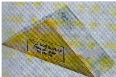
Plaque de base 316L/CU soudée par explosion (Nobelclad, Rivesaltes)
